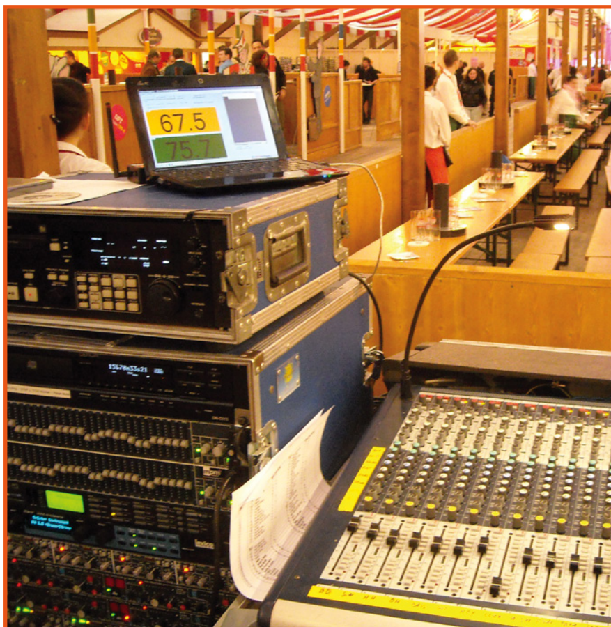
Mittels ausgeklügelter Software können Schallpegel gemessen und ausgewertet werden
